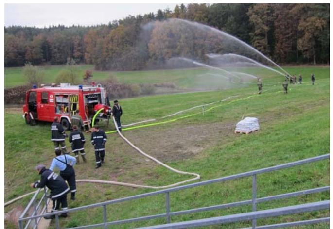
Versorgung von 6 Rohren mittels Tauchpumpe
